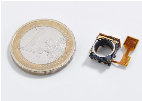
Bildunterschrift: SMA-basierendes Autofokus und optisches Bildstabilisierungssystem, für Kameras, Mobiltelefone und Smartphones
